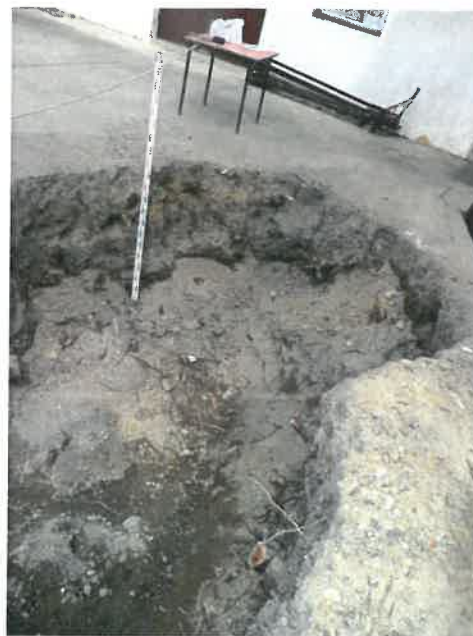
3. és 4. fotók A feltöltés heterogén anyaga az 5Nyf jelű feltárásban
