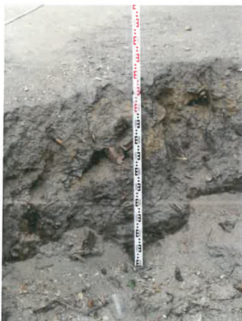
3. és 4. fotók A feltöltés heterogén anyaga az 5Nyf jelű feltárásban
